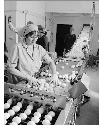
тизированного сбора и транспортирования. Эта система позволяет осуществлять доставку производимого яйца от птичников непосредственно на участок сортировки по галерям, оборудованным прутковыми транспортерами. Автоматизация процесса исключает ручной труд и в конечном итоге снижает процент боя
